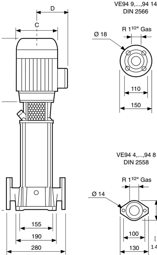
Фланцы всасывающего и напорного патрубков расположены на одной осевой линии (In-Line). Соединение между насосом и двигателем – по схеме V18 для VE 94 и V1 для VE 121.
